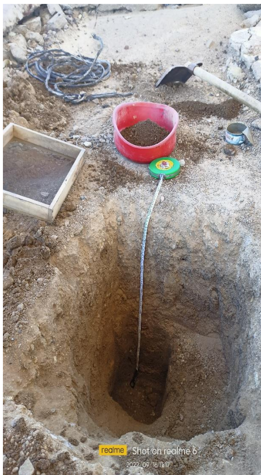
Рисунок 2 Место и метод отбора проб на ПХД.
