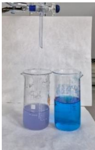
Рисунок 5 – Колонночные испытания сорбционной способности диатомита
