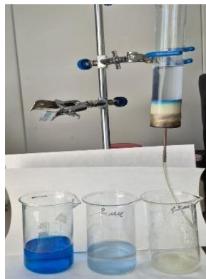
Рисунок 1 – Колоночные испытания сорбционной способности диатомита
