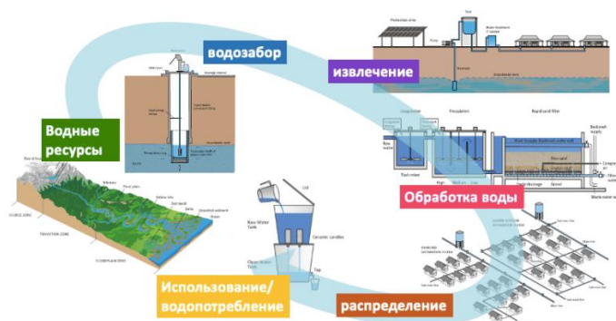
Рисунок 7– Схема водоснабжения и водоотведения потребителей Примечание: составлено автором по источнику [6, с. 27]
